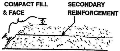
**A) LIFT 1 PLUS REINFORCEMENT FOR LIFT 2**
