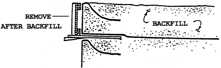
(3) PLACE/COMPACT REMAINDER OF BACKFILL LIFT
