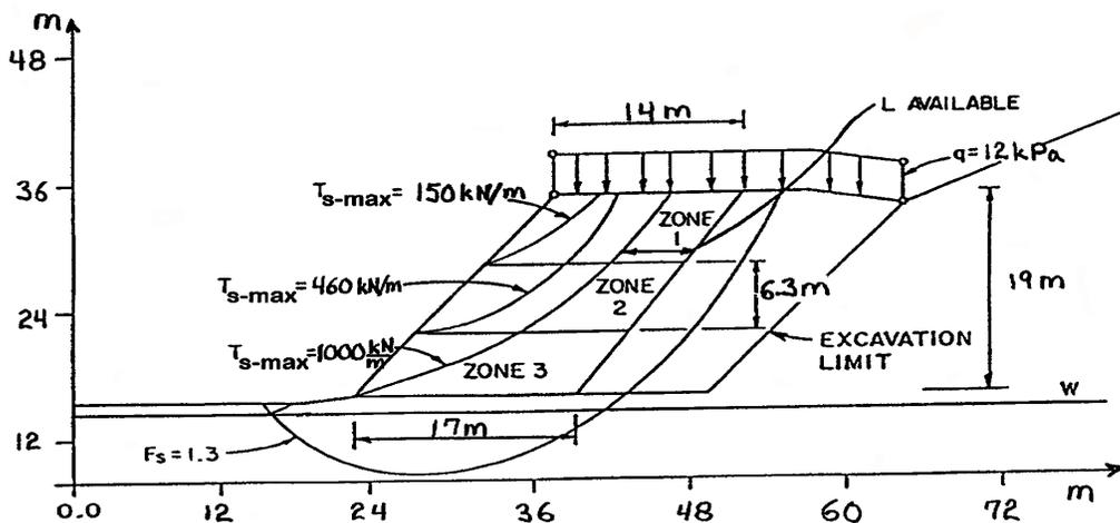
B) Step 5b : Determine  $T_{max}$
